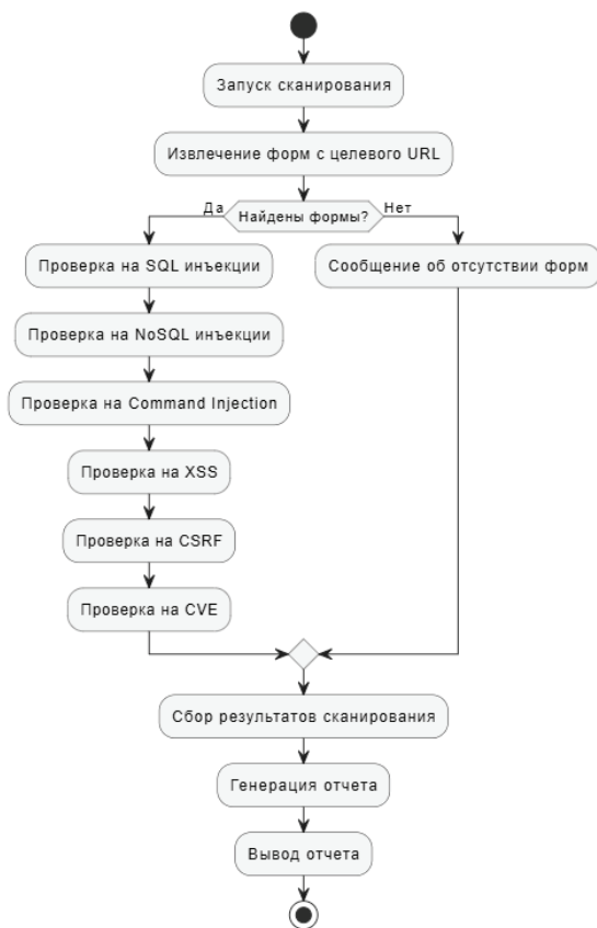
Рис. 1. Схема интеллектуального анализатора уязвимостей
