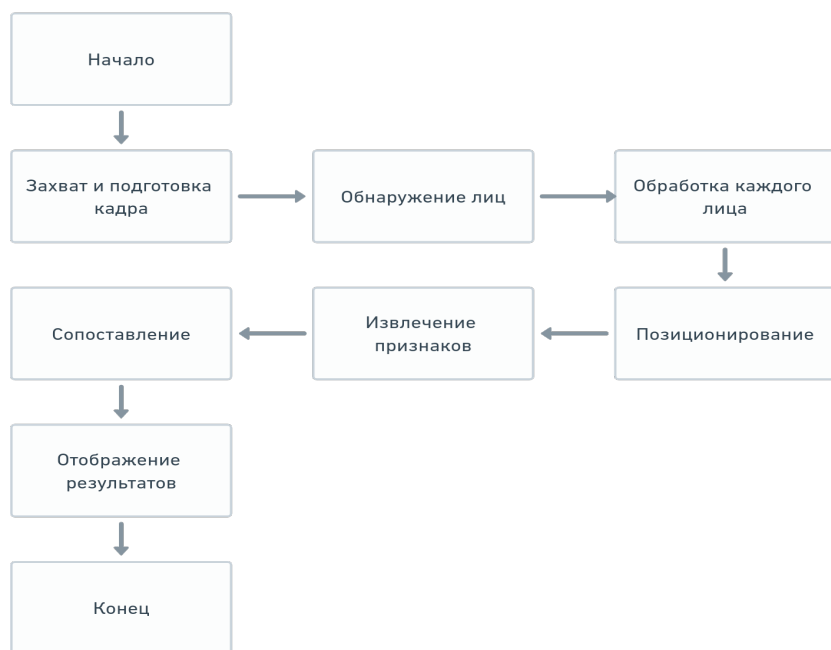
Рис. 3. Блок-схема процесса распознавания лиц в однопоточном режиме
