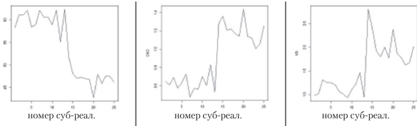
Рис. 3. Временные зависимости параметров частоты, среднего квадратичного отклонения и эквивалентной амплитуды спектра по длине реализации T
