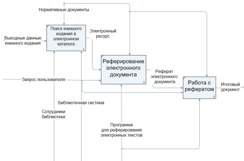
Рис. 5. Диаграмма IDEF0 уровня A1 разрабатываемой системы
