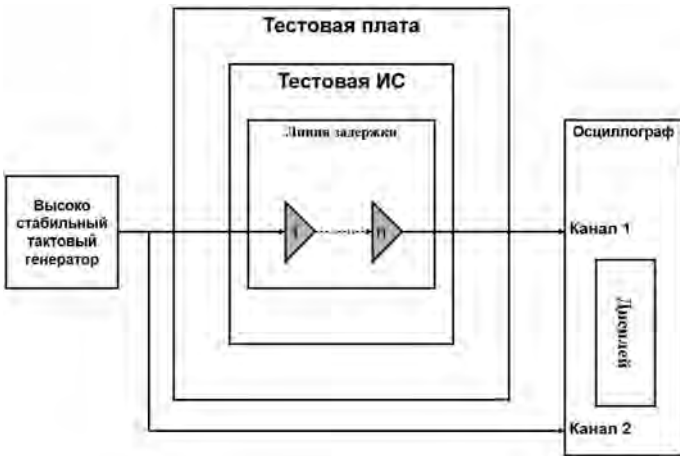
Рис. 1. Классическая схема измерения времени задержки в стандартном логическом вентиле ИС с помощью внешних измерительных приборов
