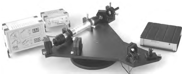
Рис. 1. Интерферометр Саньяка с гелий-неоновой активной средой
