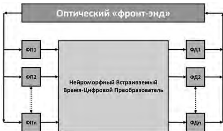
Рис. 6. Нейроморфный встраиваемый время-цифровой преобразователь с реализацией нейроморфного метода случайной выборки и обратной связью
