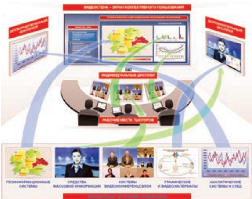
Рис. 1. Организация вывода информации на систему распределённых дисплеев
