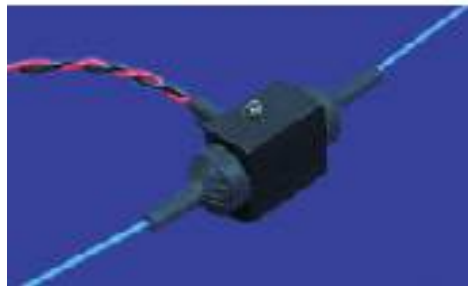
Перехватчик трафика волоконный (TAP) на основе макроизгиба волокна
