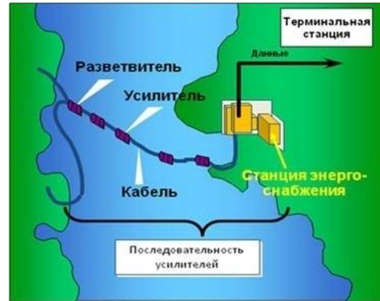
оптический кабель для подводной прокладки
